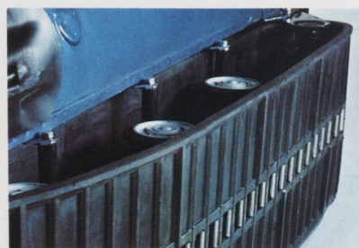
トラクション効果をよした実用新案のトラックパターン
