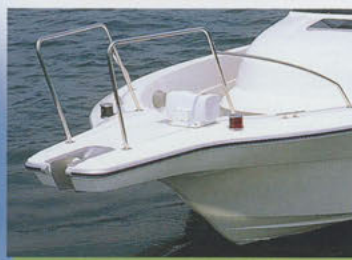
① パウスプリット&レール、パウローラー、航海灯一式 風防のアンカーウインチはオプションです。
