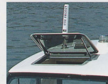
⑤ スカイライトハッチ (ブリッジ)
