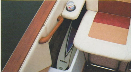
サイド物入れ 水上スキーなどが入れられる大型の物入れを、フロア両側に設置しました。アームレスト下にあるので普段は邪魔にならず機能性にすぐれています。
