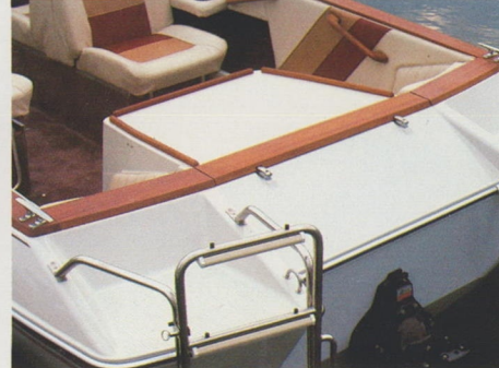
テーブル兼用ハッチ(10) エンジンハッチ兼用のテーブルです。大型なので、エンジンのメンテナンスがしやすく、テーブルとしても有効に活用できます。
