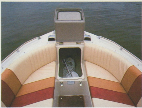
パウ物入れ バウライダー前部に、アンカーなどが入れられる物入れを装備しました。フタがシートとしても兼用でき、機能性にすぐれています。
