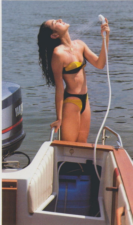
電動シャワー 後部左側のシート下に、ハンディタイプの電動シャワーを装備しました。ボート中の汗をサッパリと洗い流せる、便利でうれしい装備です。(注水20ℓタンク入り)
