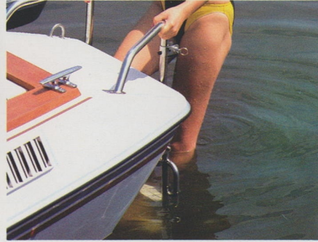
ステップラダー 艇後部から水中へラクに入ることができ、水泳や水上スキーのときなどに便利です。走行時はコンパクトに折りたたんでおくこともできます。
