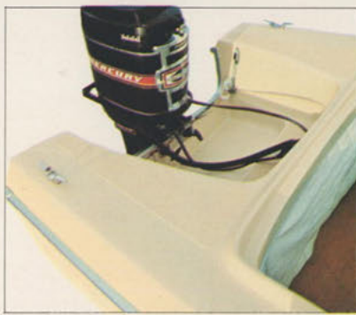
モーターウエル=水はけの良いモーターウエルは作業がしやすく、すべらないレザーパーターンです。
